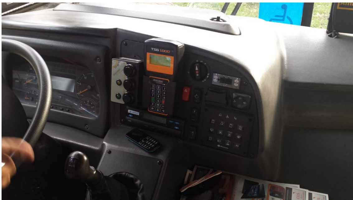
Figura 2 - Módulo de apoio à operação instalado em ônibus da Viação Piracicabana.
